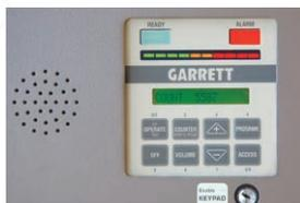
Счетчик количества проходов. Четыре режима: «Вход», «Выход», «Разница», «Сумма».
