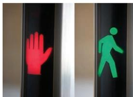
Световые табло «СТОЙТЕ /ИДИТЕ» на внешних сторонах каждой панели используются для регулирования потока людей проходящих через металлодетектор.
